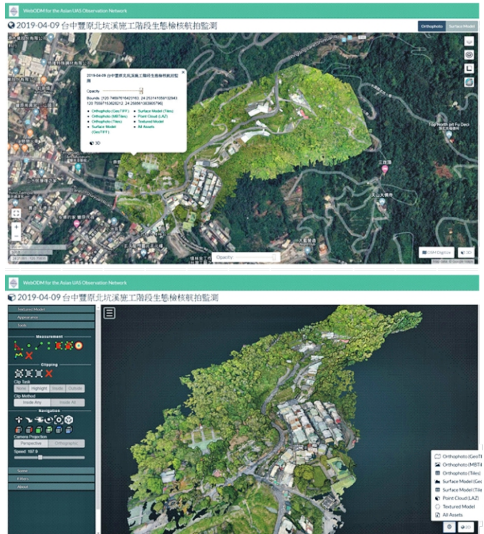
圖6.2019-04-09臺中豐原北坑溪施工階段生態檢核航拍監測2D影像及3D模型資料。
